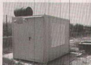
kati madde, çözünlüktü, oksjen, iletkenlik, sıcaklık ve pH parametreleri online olarak ölçülebilir. Sistemle birlikte su ve atıksu örneklerinde kirliliğin derecesinin belirlenmesinde en önemli test parametresi olan Kimyasal Oksijen İhtiyaçları, Organik maddekarbonitoksite dönmüşüz içeriği okşen miktarını ölçen ve ortaya çıkan veriler canlı olarak takip ediliyor.
